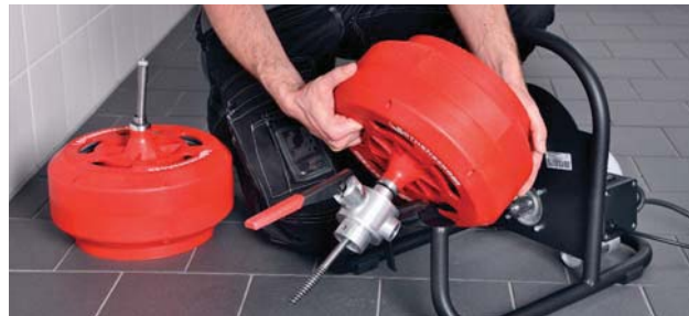
Schnelles und einfaches Umrüsten der Maschine durch Trommelwechsel (werkzeuglos)
