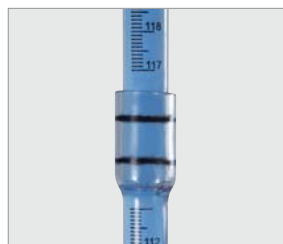
Transparente Steckrohre mit doppelter O-Ring-Abdichtung
