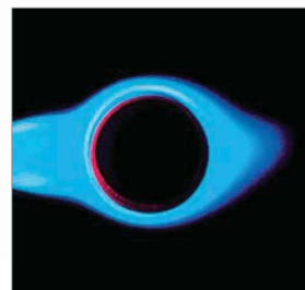
Hohe Flammentemperatur durch Zyklonverwirbelung
