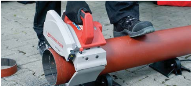
Trennen von Stahlrohren bis Ø 250 mm (PIPECUT TURBO 250)
