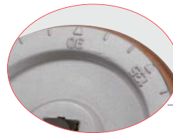
Werkzeuglose Voreinstellung des Biegewinkels
