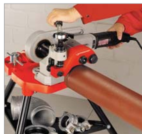
Einsatz mit Rollnutgerät ROGROOVER
